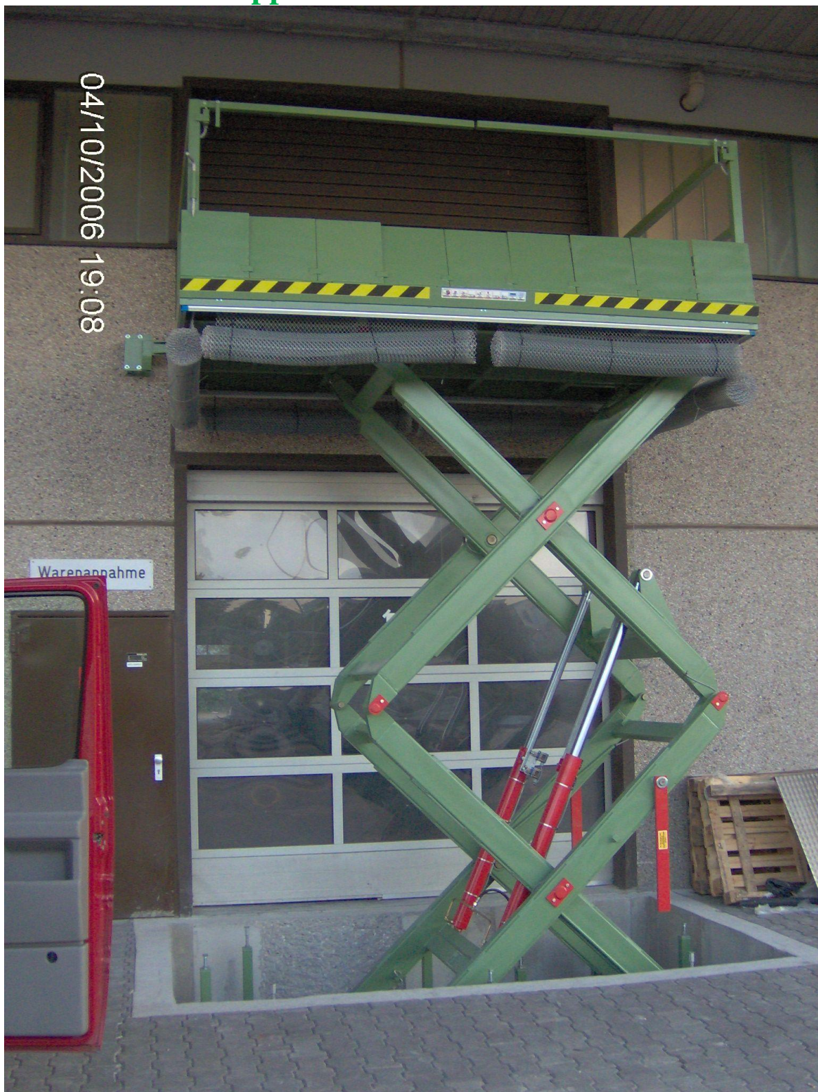
Doppelscheren Hubtisch von geba 1 Tonnen Tragkraft
